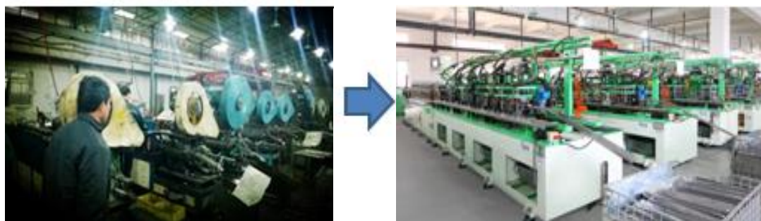
公司自动跳步模多元化冲压成型设备与传统滑轨冲压工艺对比图
