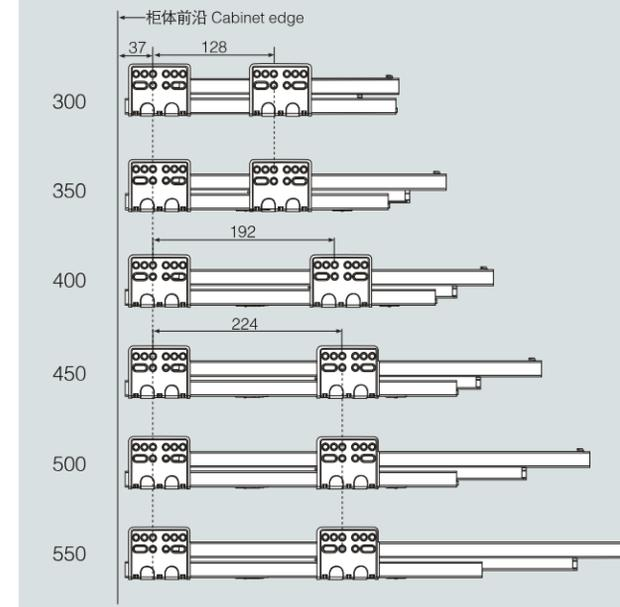
**滑轨安装尺寸 Installation size**
