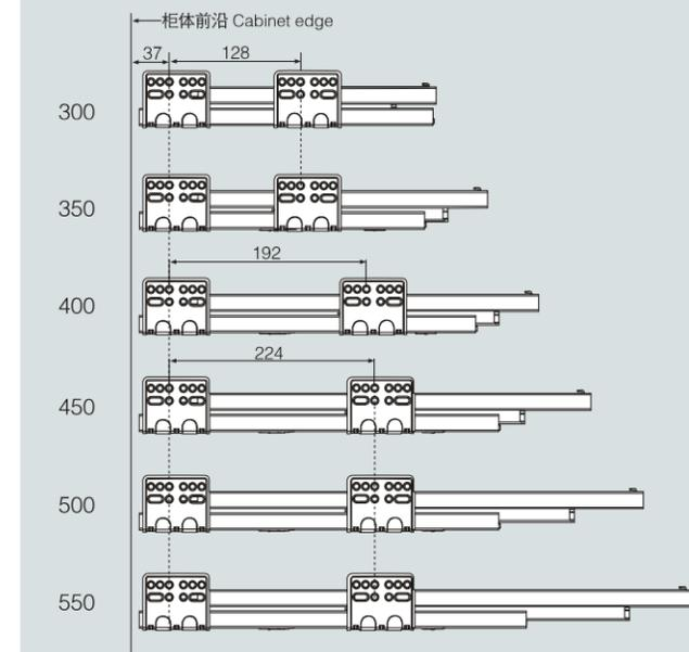
**滑轨安装尺寸 Installation size**
