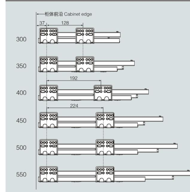
**滑轨安装尺寸 Installation size**
