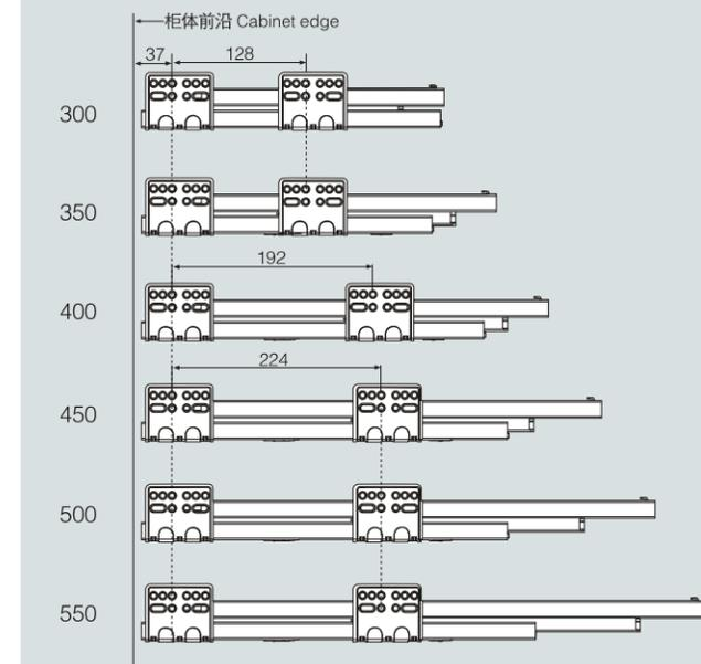
**滑轨安装尺寸 Installation size**
