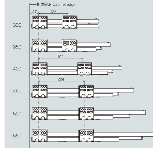
**滑轨安装尺寸 Installation size**
