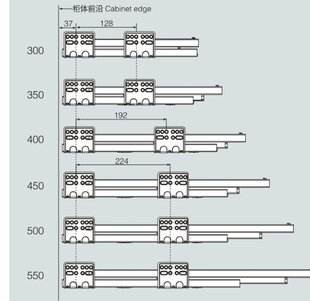
**滑轨安装尺寸 Installation size**
