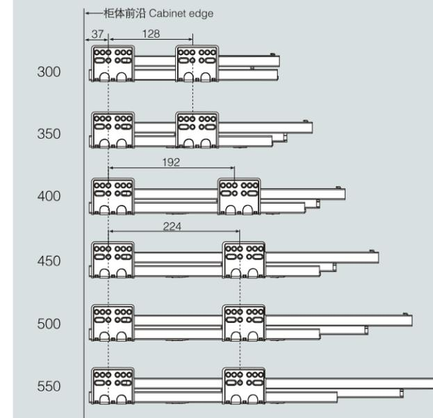
**滑轨安装尺寸 Installation size**
